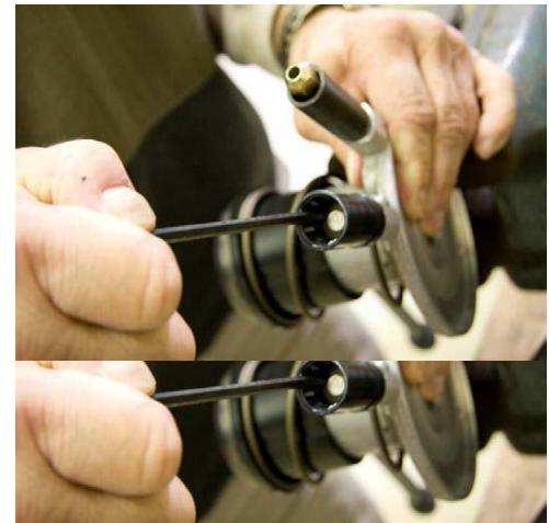
Usando una **herramienta de bloqueo, despresurice (abra) la pequeña válvula en medio del acoplamiento de conexión rápida localizada en el extremo del tubo de embrague.** (Debe tenerse cuidado para no dañar el área de válvula). Vierta fluido de frenos limpio dentro del acoplamiento y continúe adicionando fluido de frenos (líquido de frenos) hasta que un buen chorro continuo de fluido este saliendo por el tornillo de purga y no se detecte aire saliendo del CEC.
